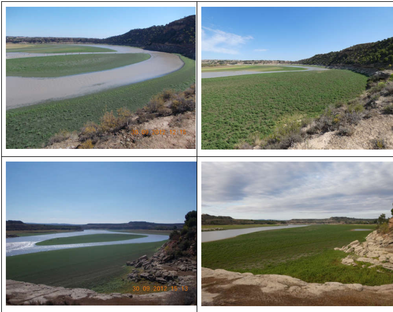
Figura 35. Evolución gráfica de la acumulación de sedimentos 2012-2022. A la izquierda fotografías de 2012. A la derecha de 2022 desde el mismo punto a nivel de embalse similar.
