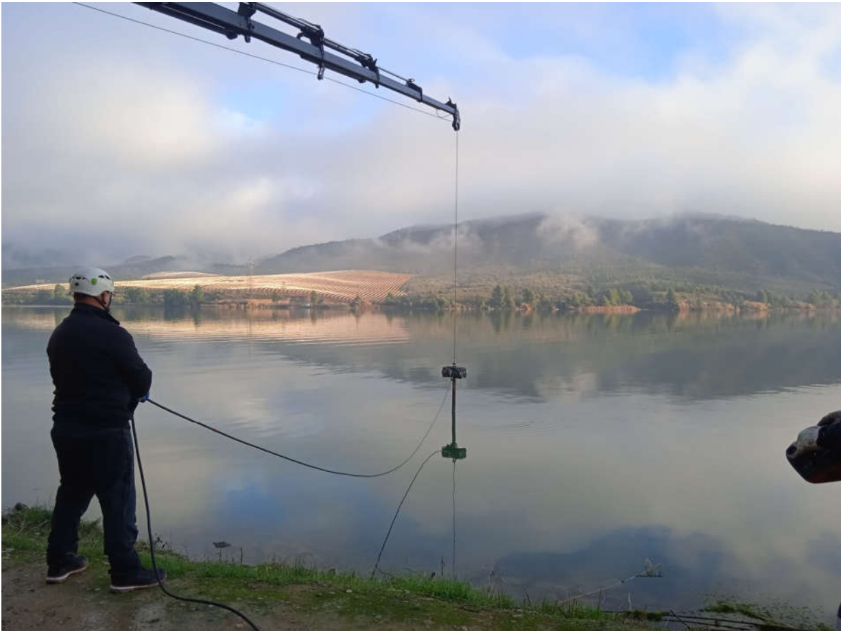
Figura 60. Ejecución de vibro- corer SVR-07.
