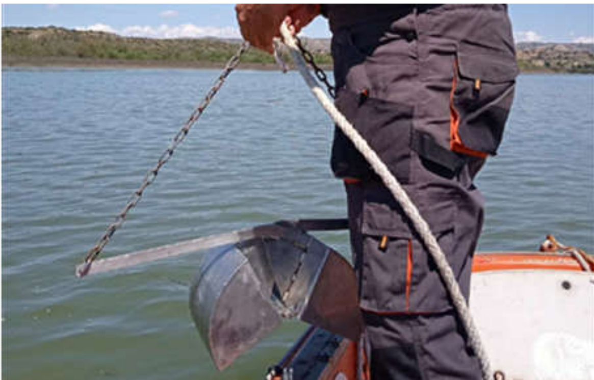
Figura 41. Detalle de cuchara Van Veen.
