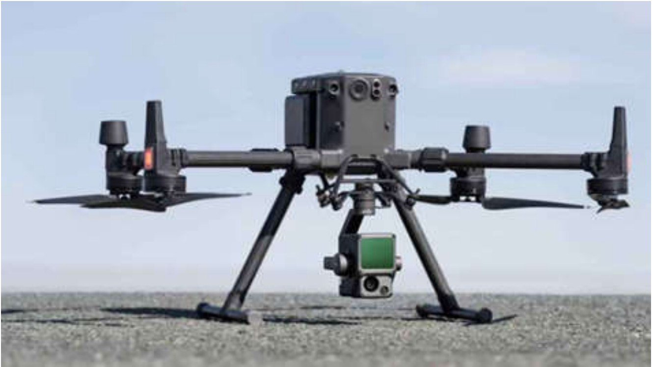
Figura 3. Dron DJI Matrice 300 RTK
