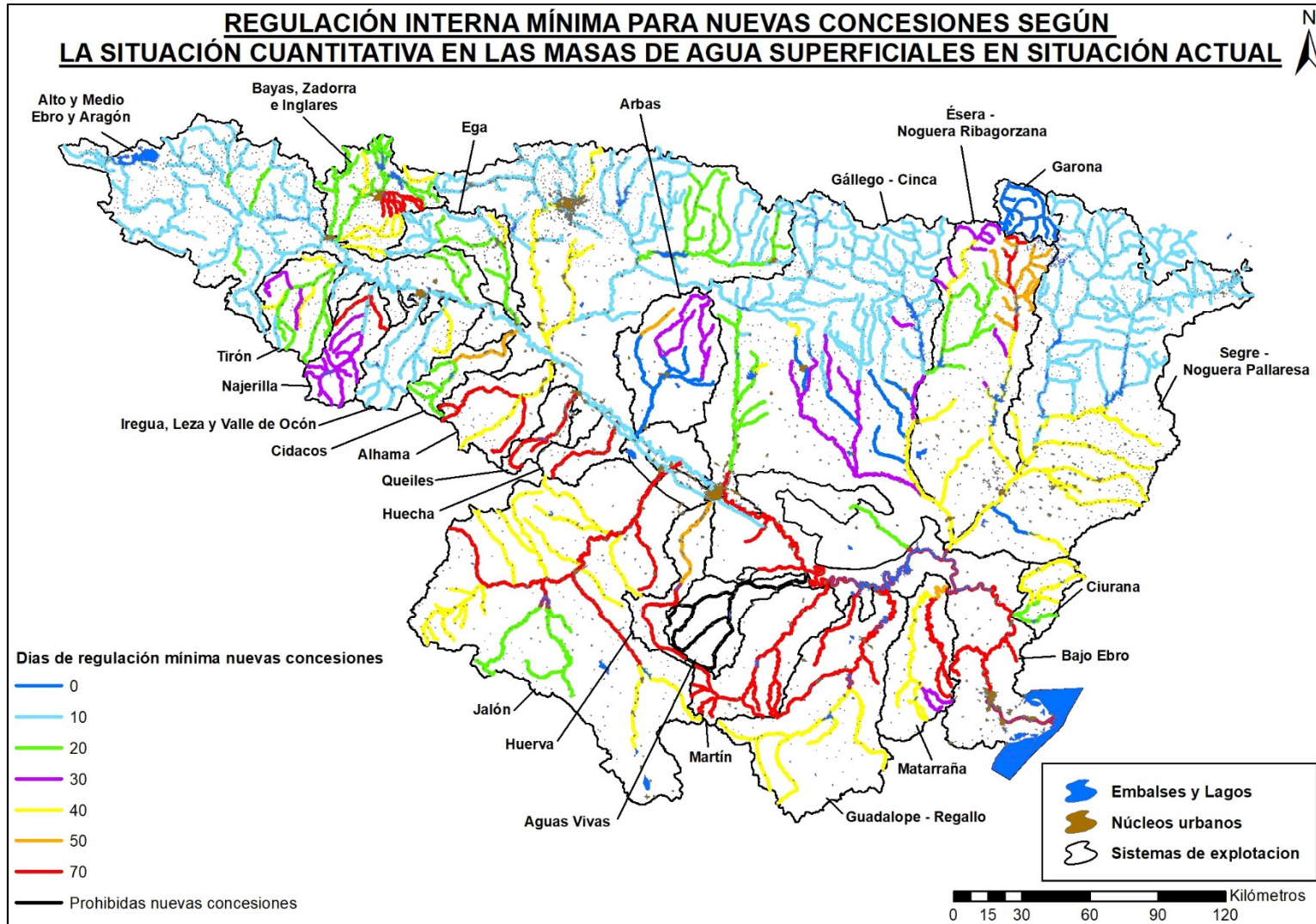
Figura 20. Regulación interna mínima para nuevas concesiones en los sistemas de explotación de la demarcación hidrográfica del Ebro según la situación cuantitativa establecida (Fuente: Elaboración propia).
