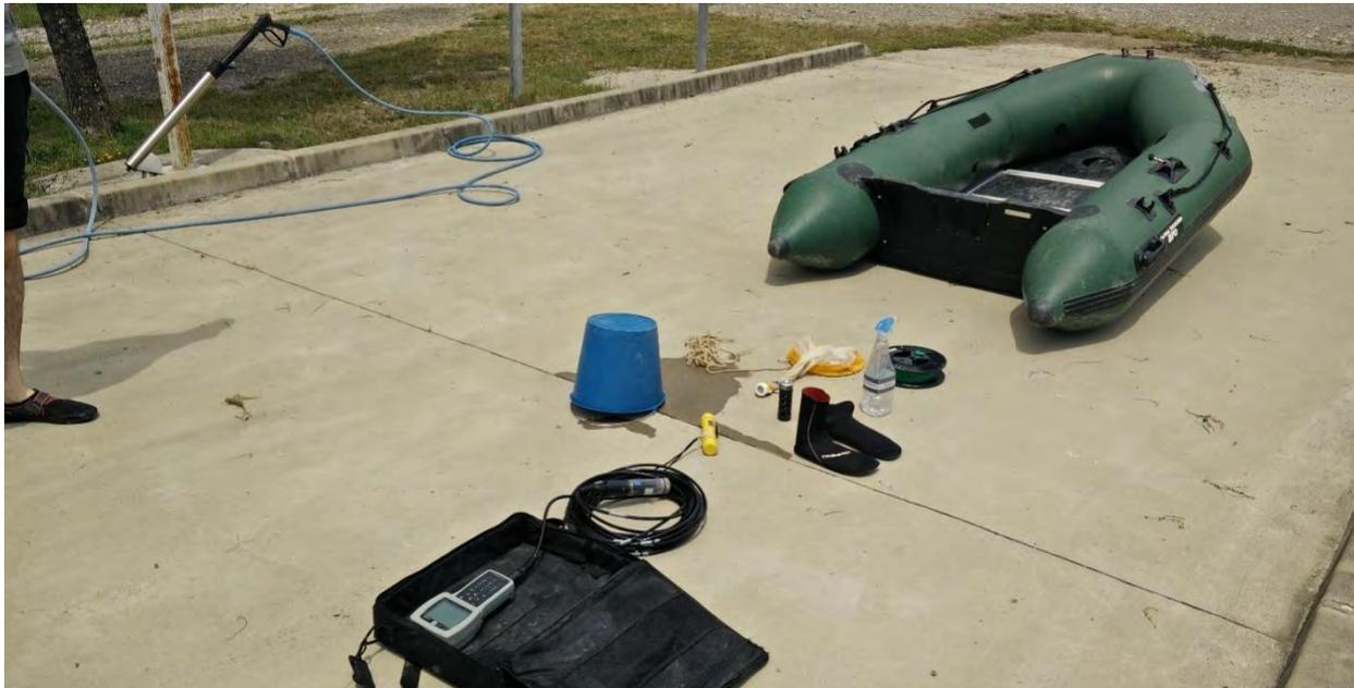
**Figura 6** Equipos de muestreo, preparados para desinfección.
