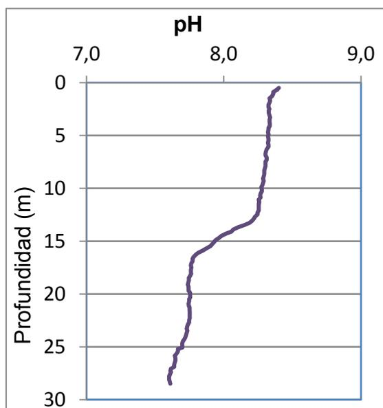
El pH del agua en la superficie es de 8,40. En el fondo del embalse el valor del pH es de 7,61. Valores máximo y mínimo del perfil.
