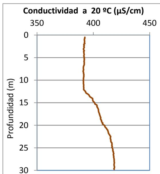
La conductividad del agua es de 392  $\mu\text{S/cm}$  en la superficie y de 419  $\mu\text{S/cm}$  en el fondo. La conductividad empieza a subir a partir de los 12 metros de profundidad.
