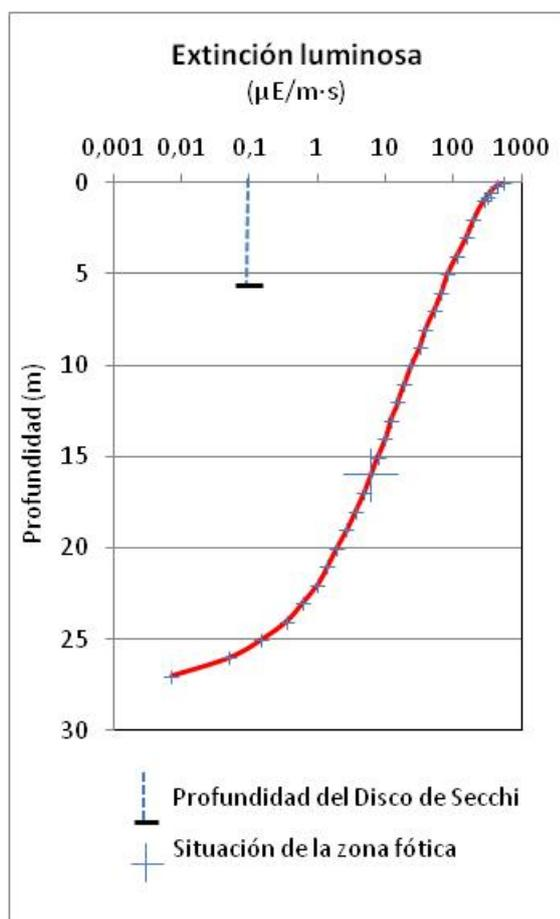
La transparencia del agua registrada en la lectura de disco de Secchi (DS) es de 5,85 metros, lo que supone una profundidad de la capa fótica en torno a 14,6 metros. Sin embargo, la determinación mediante medidor fotoeléctrico proporciona el valor de 16 m como espesor de la capa fótica.
